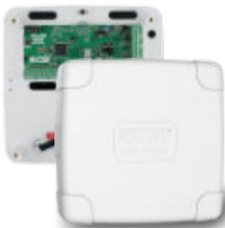
Scheda di espansione porte IO, per sistema Infinite.
