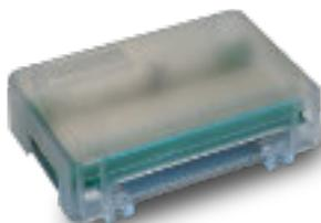
Scheda di espansione combinata porte IO e uscite open-collector, per sistema Infinite.
