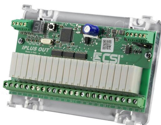
Modulo di espansione a microprocessore 32 bit in box plastico per installazione in centrale
